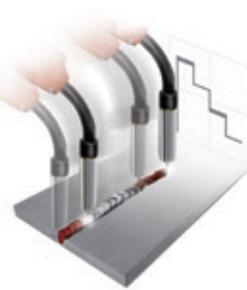
Permet de régler la valeur de la vitesse du fil pendant la phase de fin de soudure.
