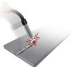
Grâce à cette fonction spéciale, on obtient la brûlure programmée du fil (procédé anti-collage) et la parfaite préparation du fil pour l'amorçage suivant.
