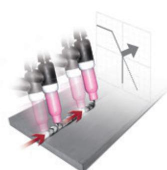
Permet l'extinction immédiate de l'arc pendant la rampe de descente ou le redémarrage du cycle de soudage.
