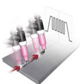
Permet de focaliser l'action et d'obtenir une meilleure stabilité de l'arc électrique.
