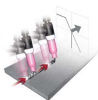
Permet l'extinction immédiate de l'arc pendant la rampe de descente ou le redémarrage du cycle de soudage.
